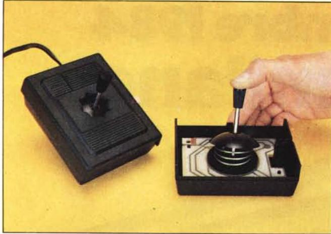
Sopra, il Joystick. La struttura del controllore di giochi non è del tutto convenzionale, ma a nostro parere assai efficace: il robusto mollone centrale ci infonde sicurezza, e la sagomatura del mobile non ammette errori. A destra, due esempi di schermate di giochi e una panoramica del software disponibile.
